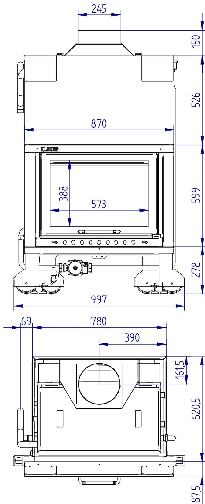
Ficha técnica de conexiones (Modelo sin KIT HIDRÁULICO)
